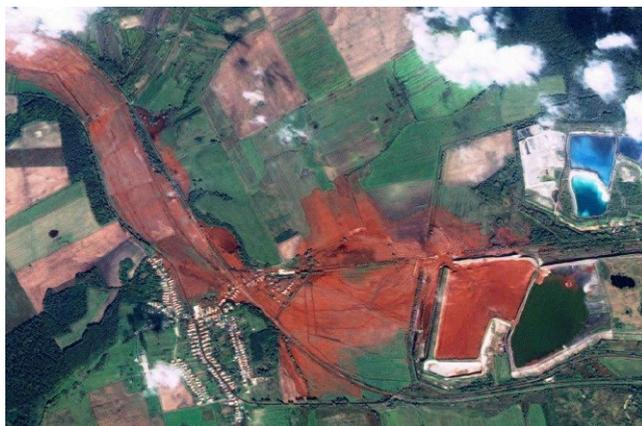
Figura 2.5: Immagine satellitare dell'area circostante dopo lo sversamento della discarica di red mud di Ajka in Ungheria [76]
