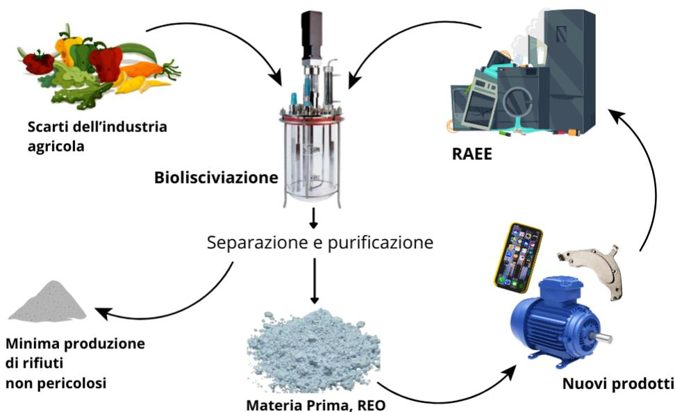
Figura 6.19: Schema del processo di riciclo di magneti NdFeB tramite biolisciviazione adoperando scarti dell'industria agricola come substrati alternativi per il metabolismo microbico secondo Jin et al. [61] (copyright immagine del bioreattore ©Steroglass S.R.L., della polvere di  $Nd_2O_3$  ©Stanford Advanced Materials)
